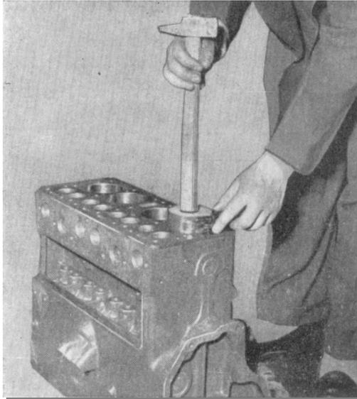
FIGURE 37. – Mise en place d'un ensemble bielle piston dans le bloc-cylindres avec l'appareil à comprimer les segments.
